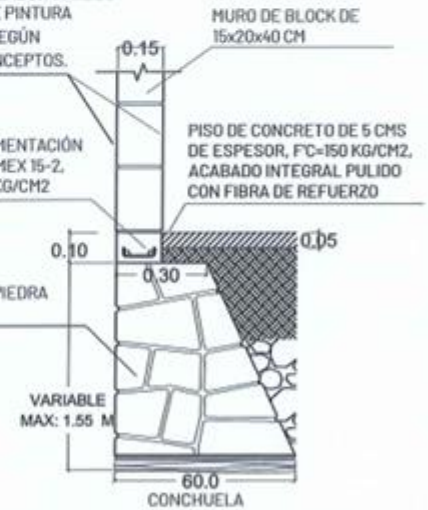
DETALLE DE CIMENTACIÓN ESC 1:20
