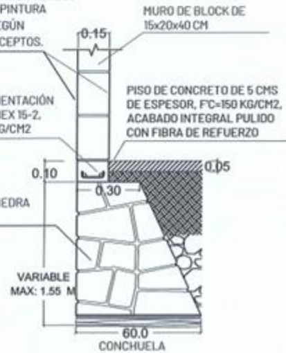
DETALLE DE CIMENTACIÓN ESC 1:20
