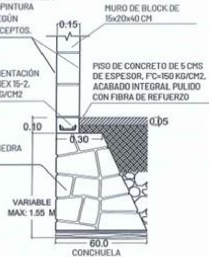
DETALLE DE CIMENTACIÓN ESC 1:20
