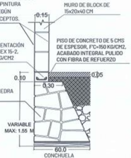
DETALLE DE CIMENTACIÓN ESC 1:20
